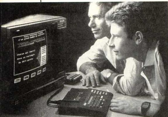
le cordon péri-télévision, le cordon magnétophone, un manuel d'utilisation en français de 96 pages reprenant l'ensemble des instructions BASIC et des exemples de programmes. La console de base a un poids de l'ordre de 820 grammes, et à des dimensions de 280 mm x 210 mm x 42 mm.
